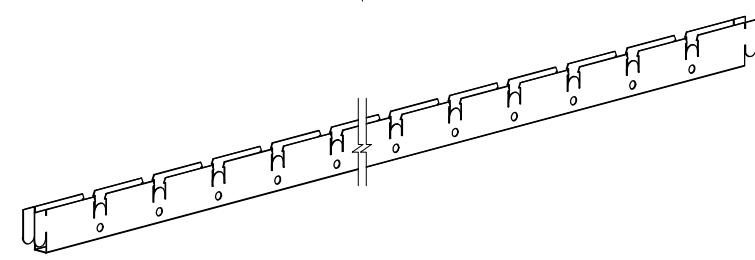
Элемент D5 – "направляющая 2400мм"
