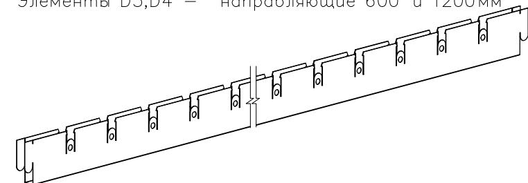
Элемент D5 – "направляющая 2400 мм"
