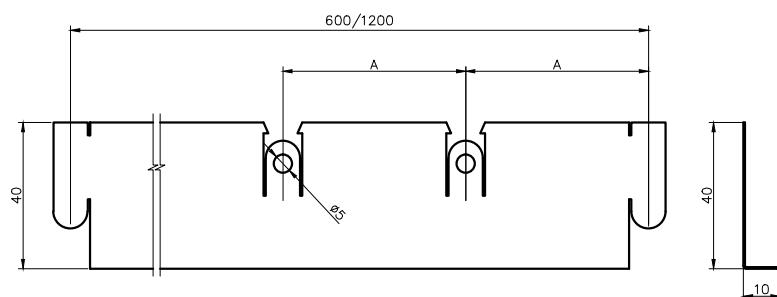
Элемент D5 – "направляющая 2400 мм"
