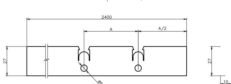
Элемент D5 – "направляющая 2400мм"
