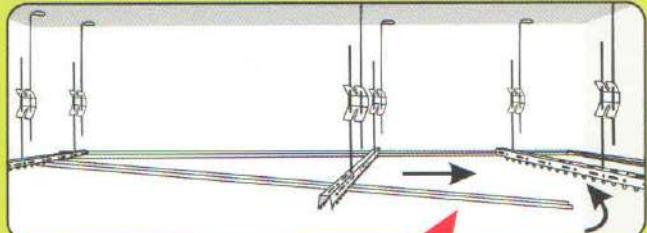
**!!!** При монтаже потолочной рейки, важно соблюдать направление монтажа, указанное стрелками на защитной пленке на каждой рейке.
